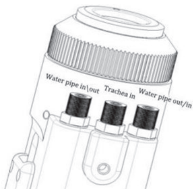
Схема подключения охлаждения и подачи газа.
